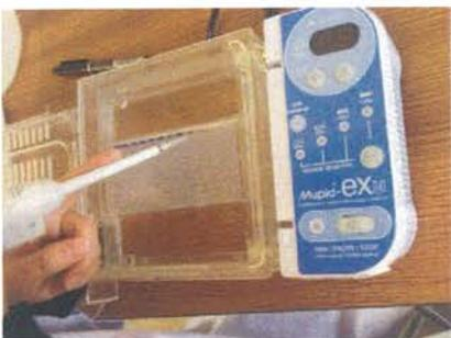
図 6. 電気泳動装置
