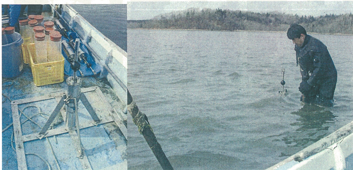
図6 流速計設置方法 (左図：流速計架台、右図：流速計設置作業)
