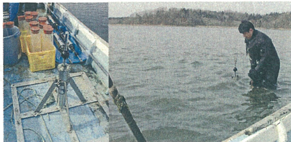
第2図 流速計設置方法(右:架台、左:埋設)
